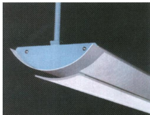
Pendelleuchte für die Bestückung mit modernen T5-Leuchtstofflampen. Gehäuse aus verzinktem Stahlblech, weiß pulverbeschichtet, mit partiellem Siebblecheinsatz, hinterlegt mit Diffusorfolie. Das unter der Leuchte angebrachte, dem Leuchtenradius angepaßte Glasschwert ist einseitig mattiert.
